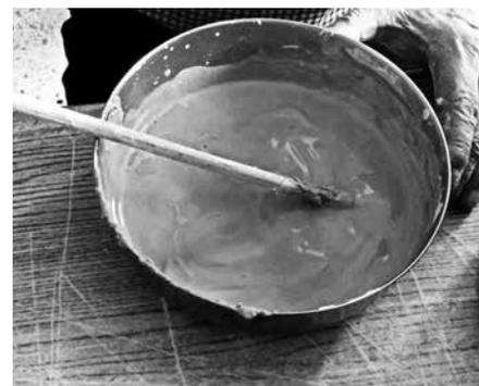
Figura 5. Segunda prueba con arcilla beige. Resultado: no hubo desfloculamiento, sólo una mezcla similar a un engobe.
