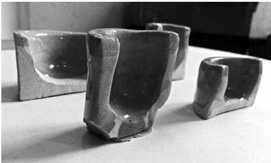
Figura 12. Pruebas exitosas de vidriado en material beige.
