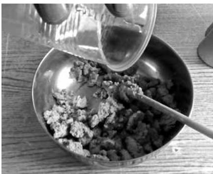
Figura 4. Prueba de desfloculación de arcilla beige. Tixotropía gruesa.
