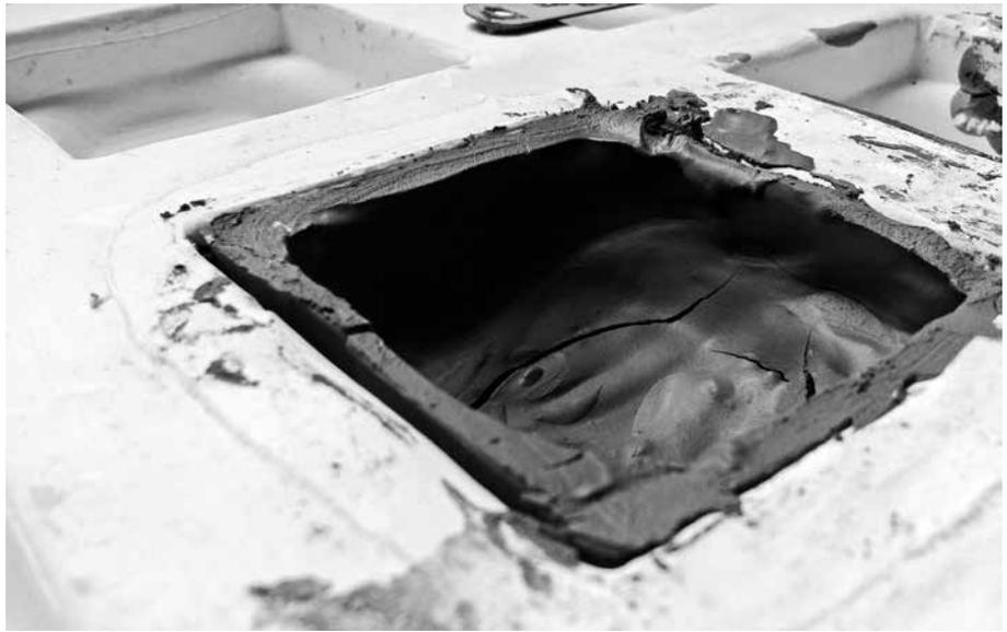
**Figura 7.** Segunda prueba de desfloculación de arcilla siena. Resultado: se obtuvo pasta con buena fluidez, al vaciarse en un molde de yeso se formó una pieza que al deshidratarse fracturó.
