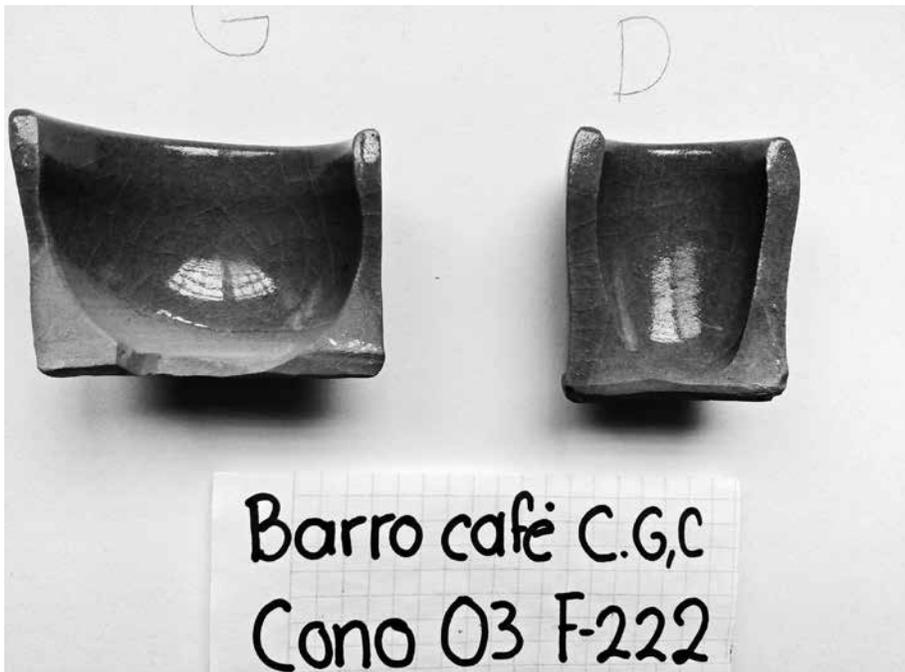
Figura 11. Pruebas exitosas de vidriado en material siena.
