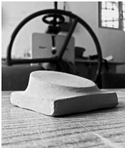
**Figura 8.** Tercera prueba de desfloculación de arcilla siena. Resultado: se obtuvo barbotina fluida para formar adecuadamente piezas en moldes de yeso.
