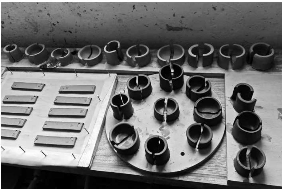
Figura 3. Prueba de plasticidad en el torno.
