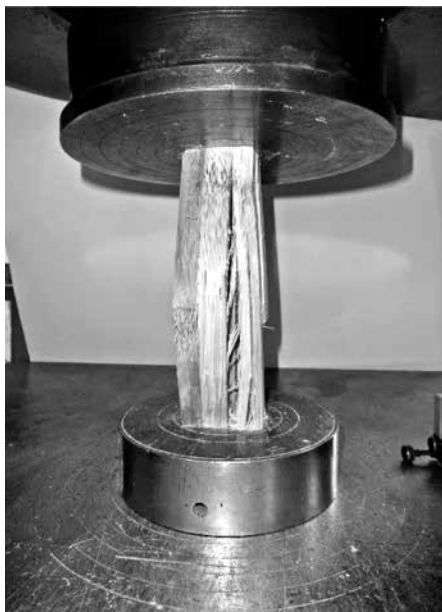
Figura 27. Ensaye a compresión paralela a la fibra de las probetas OLLCA.
