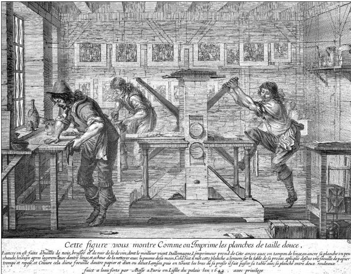
Figura 1. Famosa estampa de Abraham Bosse de 1642 que muestra un taller de impresión del siglo XVII. Describe el entintado con tampón, la limpieza de la plancha con la palma de la mano y la impresión del grabado de talla dulce por medio de una prensa o tórculo. Fuente: Western European Prints, Aurora Art Publisher, Leningrad.
